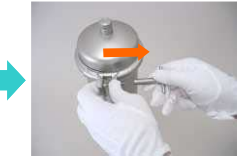
4 ①締め付けバンドのウイングナットを左に廻し、
