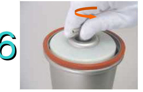
4 ①締め付けバンドのウイングナットを左に廻し、
