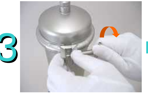
3 ②水の噴き出しが無くなったら、エア抜きノズルを右に廻し、締めつけてください
