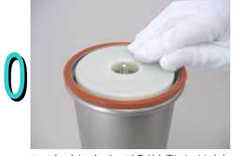
9 センターシャフトウイングナットを取り外します。
