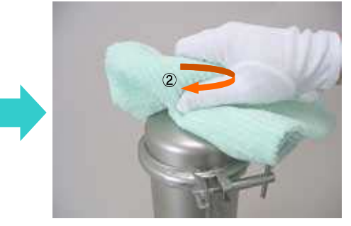
2 ①エア抜きノズルを左にゆっくり廻して本体内の圧力を抜きます 注意:このとき、内部の水が噴き出すので、タオル等で覆いながら作業してください
